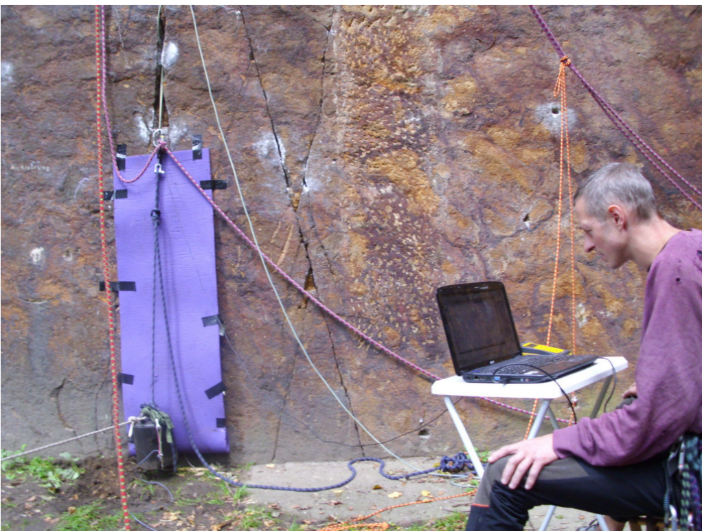
Auswertung der Kraftmessung; die Schlinge hat gehalten.
